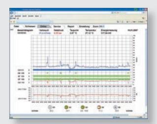
Alle Daten werden in hoher Auflösung (1x/Sek.) berechnet und in Diagrammen übersichtlich dargestellt – für eine präzise Beurteilung der gesamten Druckluftstation.
