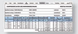
Die komplette Energiebilanz Ihrer Anlage wird auf einen Blick sichtbar: Last- und Leerlaufzeiten, verbrauchte kWh, erzeugte m³, spezifische Leistung, Energiekosten in EUR, Motorstarts und Lastwechsel.
